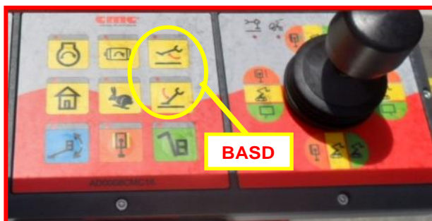
Afbeelding 27: knoppen automatische stabilisatie/destabilisatie bedieningspost in de korf.
